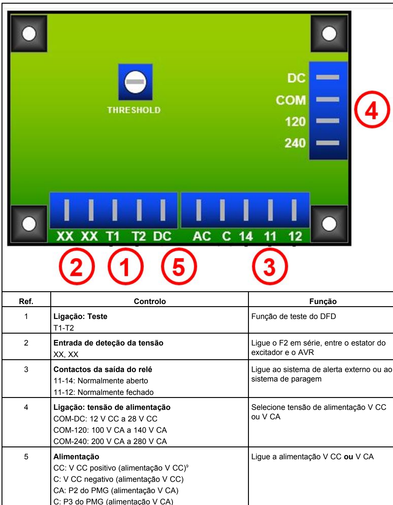
FIGURA 5. CONTROLOS DO DETETOR DE FALHAS DO DÍODO
