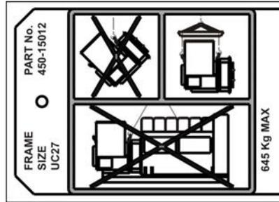
FIGURA 18. ETICHETTA CON CONFIGURAZIONE DI SOLLEVAMENTO
