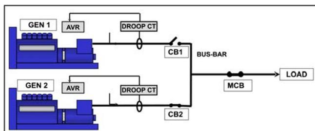
FIGURA 24. ALTERNATORI IN PARALLELO O A SINCRONIZZAZIONE
