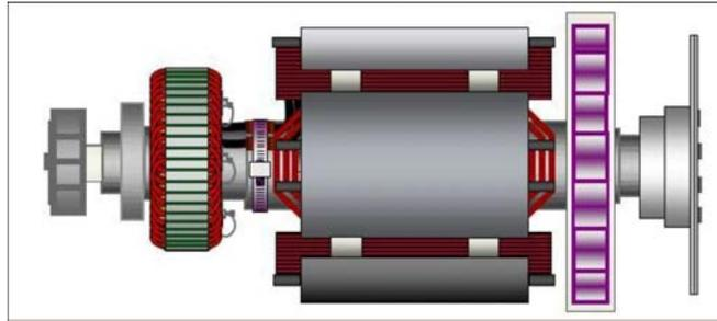
**FIGURA 20. ROTORE DELL'ALTERNATORE MONOCUSCINETTO CON DISCHI DI ACCOPPIAMENTO AVVITATI AL MOZZO DI ACCOPPIAMENTO LATO CONDUTTORE (A DESTRA)**
