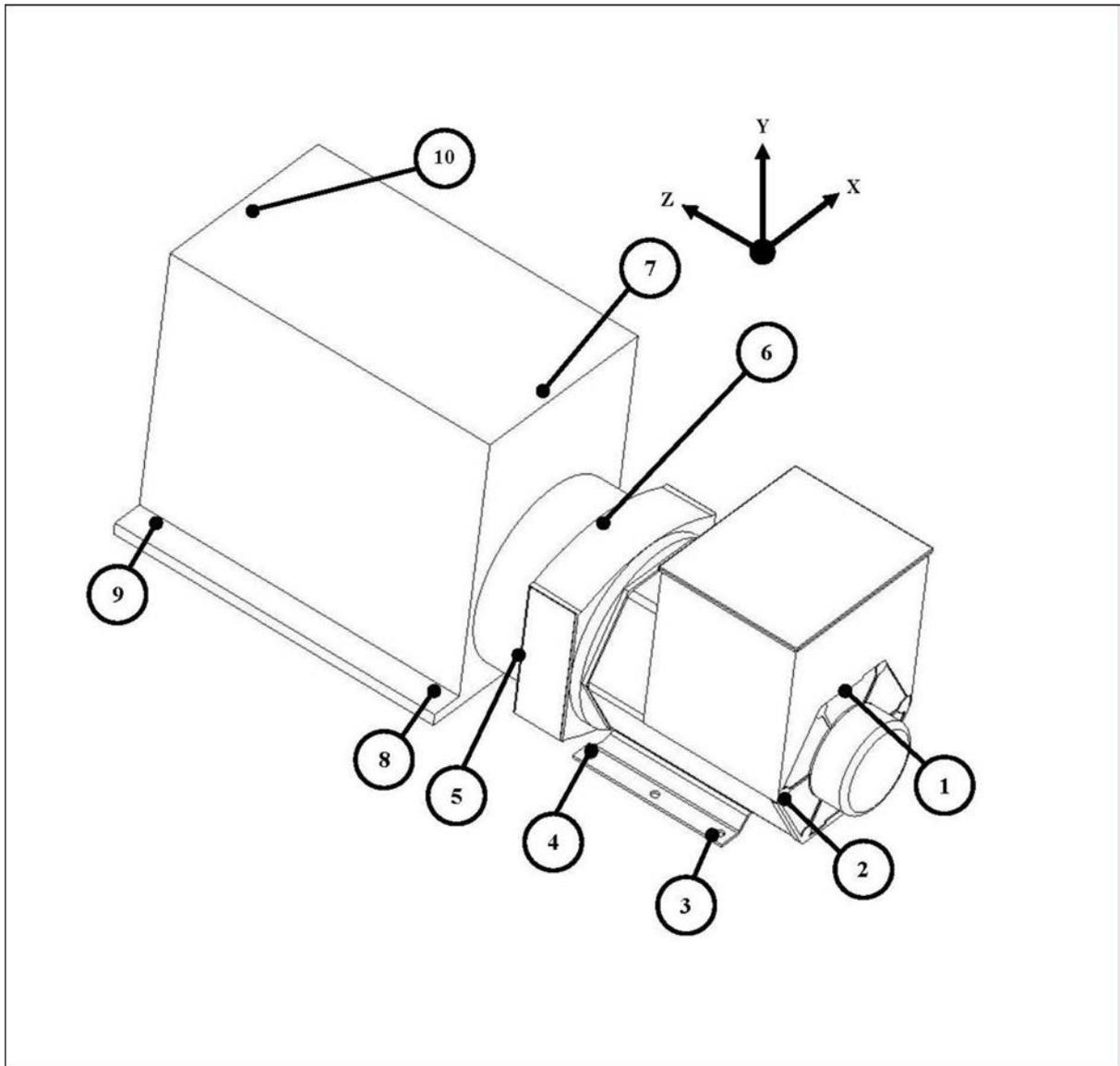
**FIGURA 17. PUNTI DI MISURAZIONE DELLE VIBRAZIONI**
