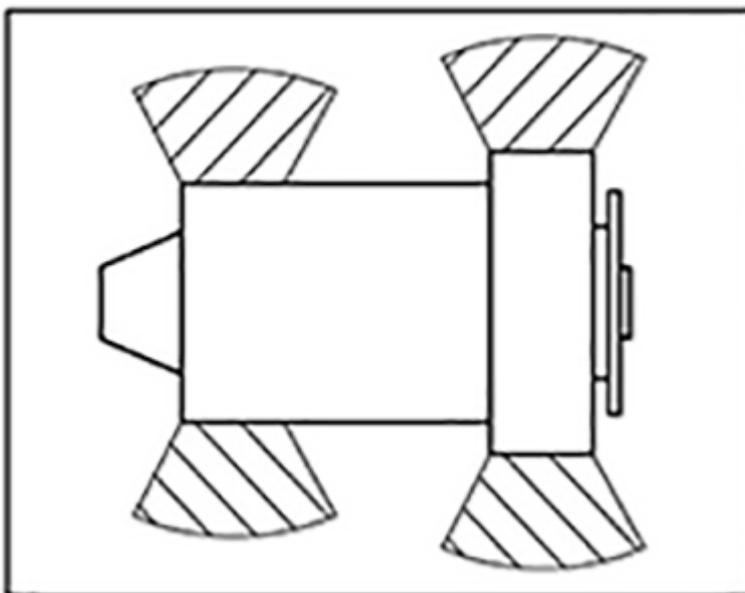
РИС. 5. S0/S1 ОПАСНЫЕ ЗОНЫ ГЕНЕРАТОРА ПЕРЕМЕННОГО ТОКА
