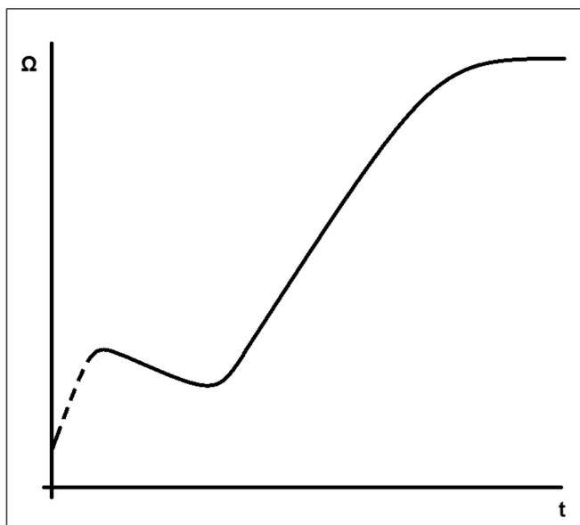
РИС. 26. ГРАФИК СОПРОТИВЛЕНИЯ ИЗОЛЯЦИИ
