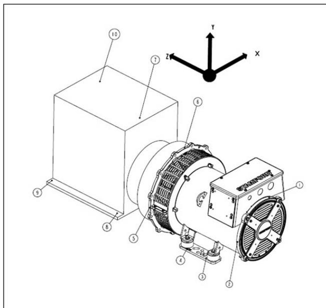
РИС. 17. ПОЛОЖЕНИЯ ИЗМЕРЕНИЯ ВИБРАЦИИ
