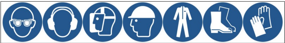
ABBILDUNG 1. MINDESTENS ERFORDERLICHE PERSÖNLICHE SCHUTZAUSRÜSTUNG (PSA)
