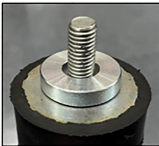
РИС. 6. ПЛОСКАЯ ШАЙБА, УСТАНОВЛЕННАЯ НА ВЕРХНЕЙ ЧАСТИ АНТИВИБРАЦИОННОГО КРЕПЛЕНИЯ
