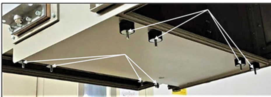
図 7. 水冷クーラーの下側に取り付ける 6 MM ワッシャーを含む防振マウント 8 個。
