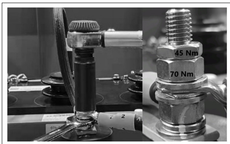
FIGURA 19. FIXAÇÃO CORRETA DOS CABOS (MÚLTIPLOS CABOS)
