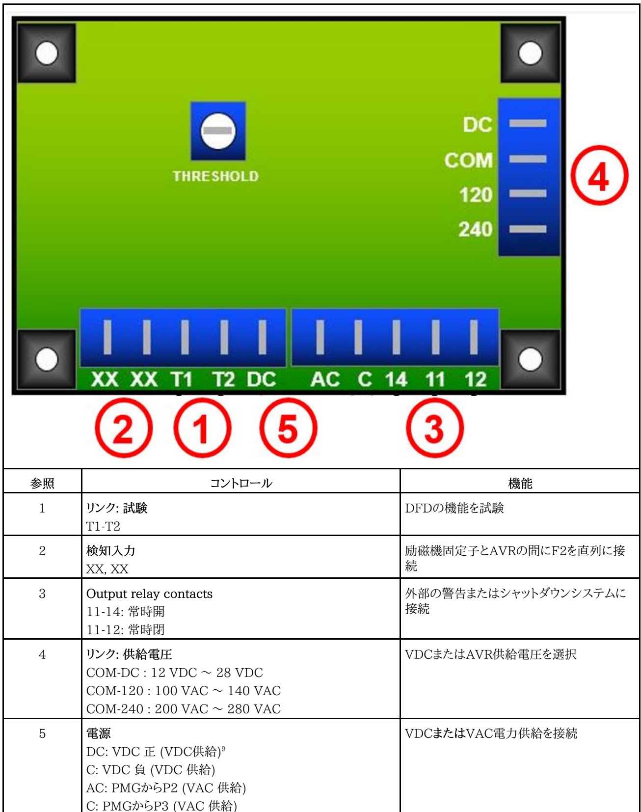
図 5. ダイオード故障検出器コントロール
