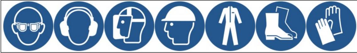
الشكل 1. الحد الأدنى الموصى به من معدات الحماية الشخصية (PPE)
