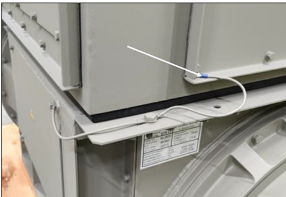
RYSUNEK 11. PRZEWÓD UZIEMIAJĄCY
